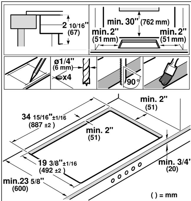
**Pose en affleurement:** L'appareil peut être posé en affleurement dans un plan de travail.
