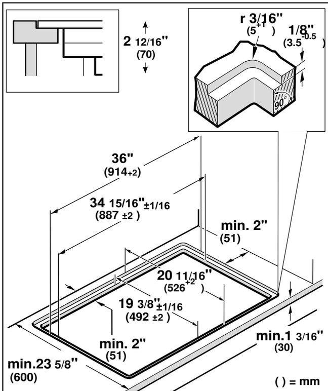
**Pose en affleurement:** L'appareil peut être encastré dans des plans de travail résistant à la chaleur et à l'eau, fabriqués dans les matériaux suivants :
