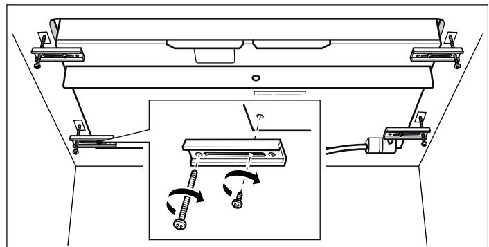
L'appareil doit être fixée au plan de travail pour éviter glissement avec les supports de fixation fournis.
