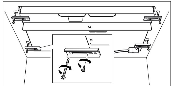
La placa debe asegurarse a la superficie de trabajo con los soportes de sujeción provistos, así que no se puede mover.
