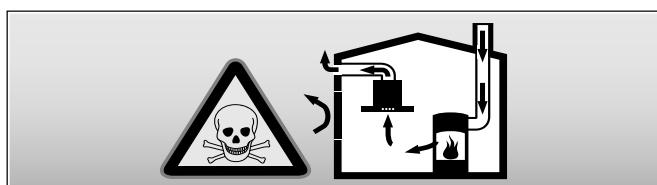
Os equipamentos de aquecimento que consomem o ar ambiente (p.ex. sistemas de aquecimento a gás, óleo, lenha ou carvão, esquentadores, cilindros) utilizam para a combustão o ar do local de montagem e transportam os gases de combustão para o exterior através de um sistema de exaustão (p.ex. uma chaminé).
