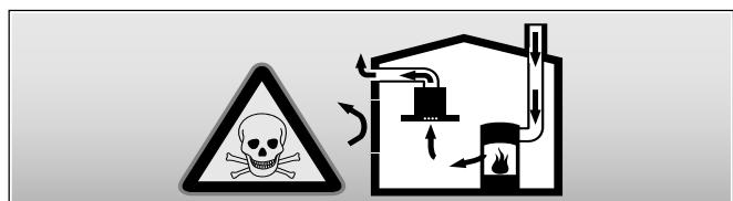
Εστίες, εξαρτημένες από τον αέρα του περιβάλλοντος (π.χ. συσκευές θέρμανσης που λειτουργούν με αέριο, πετρέλαιο, ξύλο ή άνθρακα, ταχυθερμοσίφωνες, θερμαντήρες νερού) λαμβάνουν τον αέρα για καύση από το χώρο τοποθέτησης και οδηγούν τα καυσαέρια μέσα από μια εγκατάσταση απαγωγής των καυσαερίων (π.χ. καμινάδα) στον έξω χώρο.
