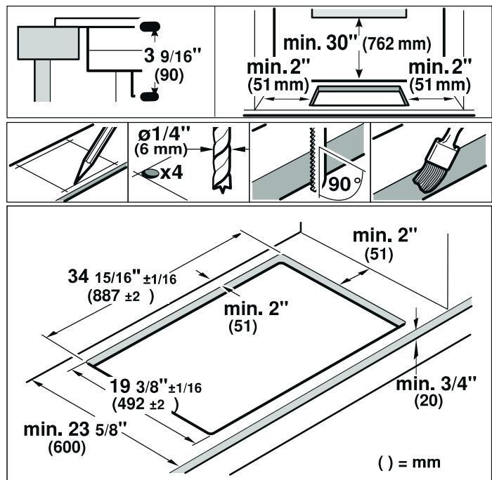
**Pose en affleurement:** L'appareil peut être posé en affleurement dans un plan de travail.
