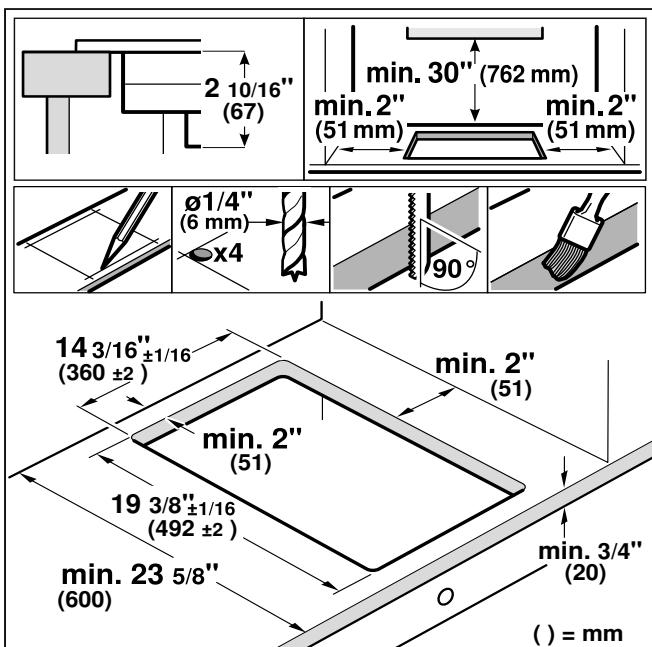
**Montaje a ras de superficie:** se puede realizar un montaje a ras de superficie de la encimera. No monte el aparato por debajo del borde superior de la encimera.
