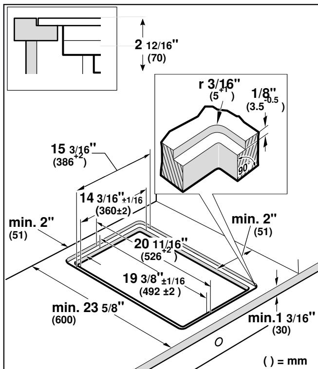
**Montaje a ras de superficie:** El aparato se puede montar en las siguientes encimeras resistentes a la temperatura y al agua:
