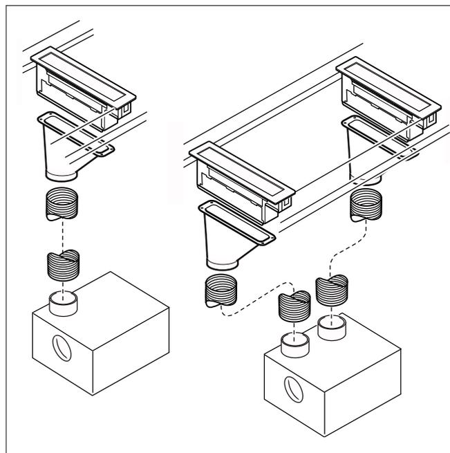
6 Mettre le filtre à graisse en place :
