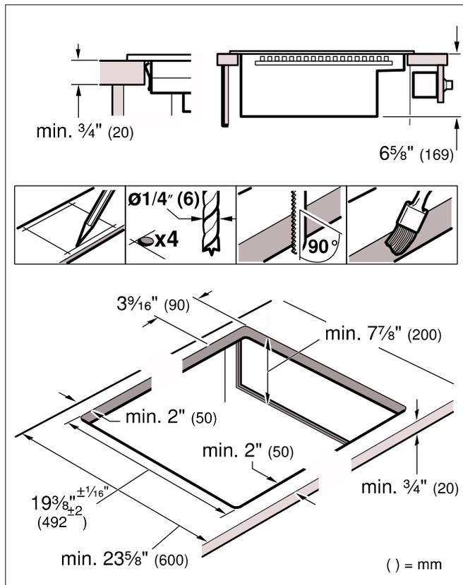
**Montaje a ras de superficie:** se puede realizar un montaje a ras de superficie de la encimera.
