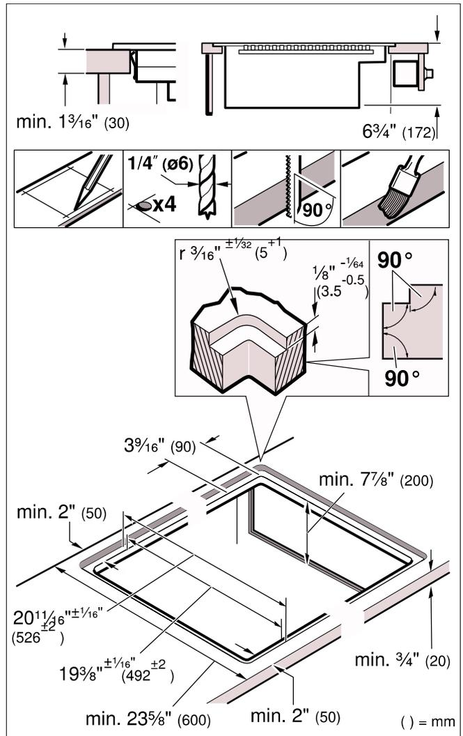
**Pose en affleurement:** L'appareil peut être encastré dans des plans de travail résistants à la chaleur et à l'eau, fabriqués dans les matériaux suivants :
