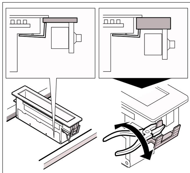
Insérer l'appareil à l'horizontale dans la découpe et l'aligner. À l'aide de la vis, serrer le blocage de plan de cuisson arrière à l'intérieur de l'appareil. Serrer le blocage de plan de cuisson avant depuis le bas.
