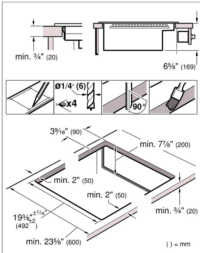
**Pose en affleurement:** L'appareil peut être posé en affleurement dans un plan de travail.
