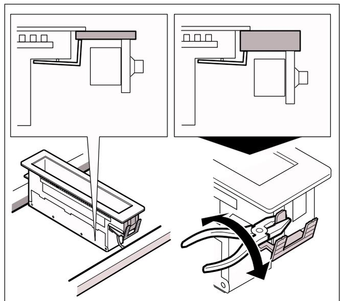
Introducir en posición horizontal el aparato en el agujero y alinearlos. Apretar el tensor de la zona de cocción con los tornillos en la parte interior del aparato. Apretar el tensor de la zona de cocción delantero desde abajo.
