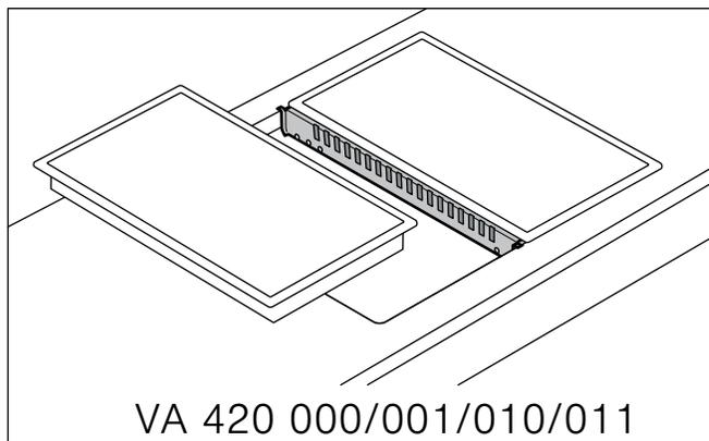
Les appareils peuvent également être installés dans des découpes séparées, en respectant une distance minimale de 2" (51 mm).
