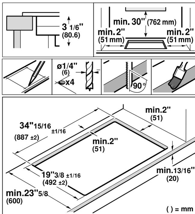
**Pose en affleurement:** L'appareil peut être posé en affleurement dans un plan de travail.
