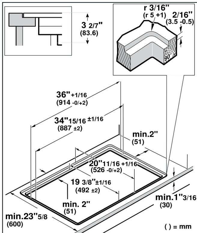
L'appareil peut être encastré dans des plans de travail résistant à la chaleur et à l'eau, fabriqués dans les matériaux suivants :
